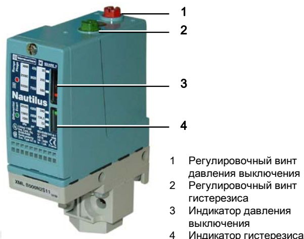
Рис. 61 Выключатель конечного давления для полноавтоматического режима
